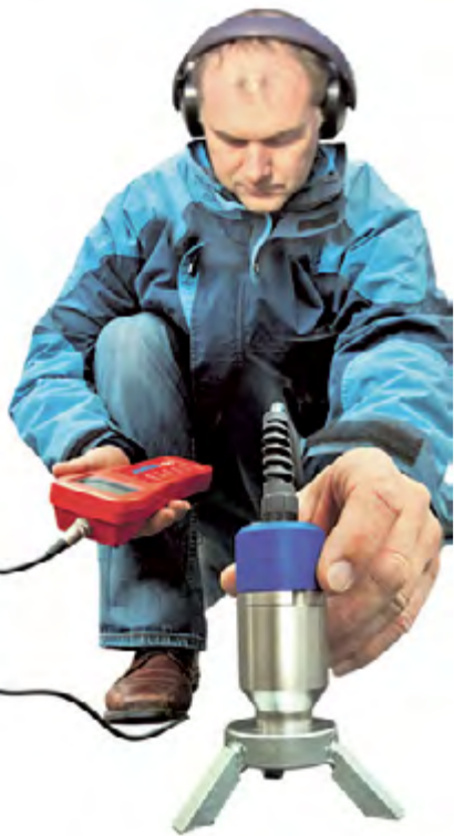
Mit hochsensibler Technik werden Wasserverluste aufgespürt. Heiko Bartel, Mitarbeiter Dispatching/ techn. Controlling.
