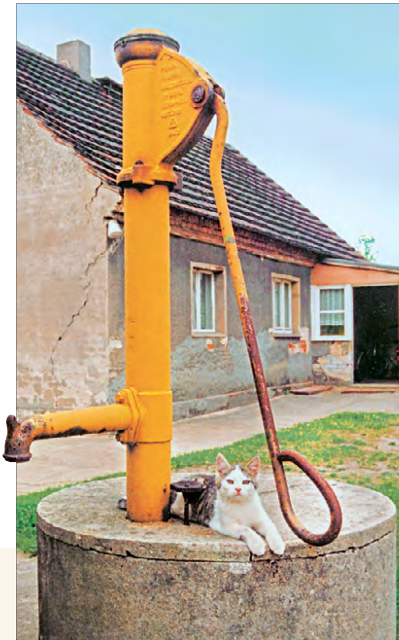
Jahrzehntelang bis in die 50er Jahre versorgten Schwengelpumpen, vor allem im ländlichen Bereich, die Bevölkerung mit Trinkwasser.
