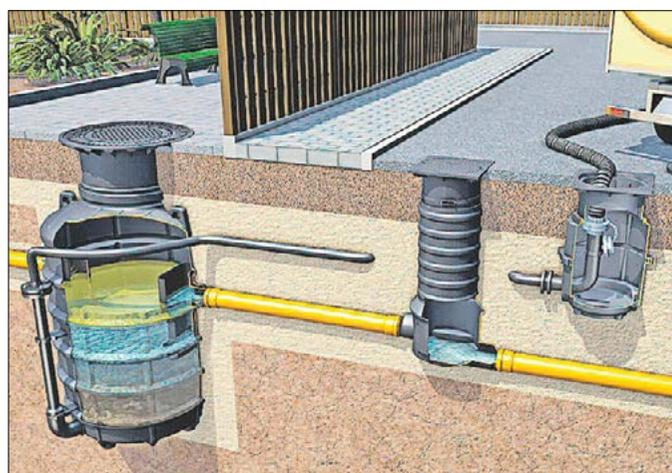
**Nicht jedes Schmutzwasser darf einfach in die Kanalisation geleitet werden. Das gilt vor allem für stark mit Fetten belastetes Abwasser. Daher sind für viele Gewerbe- und Industriebetriebe zur Vorreinigung Fettabscheider vorgeschrieben.**
