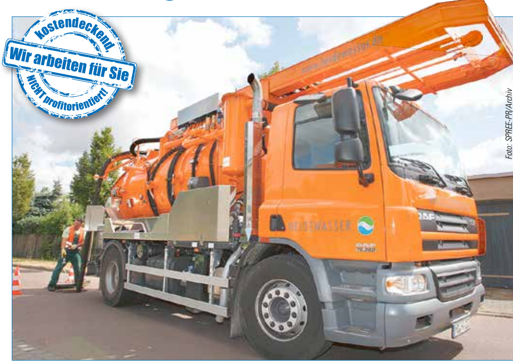
Ein Kraftprotz in Diensten Ihres Abwasserentsorgers. Der Saugwagen des Betriebsführers Heidewasser GmbH fährt regelmäßig dezentrale Grundstücke an, um das Schmutzwasser aus Kleinkläranlagen und Sammelgruben abzupumpen und abzufahren.
