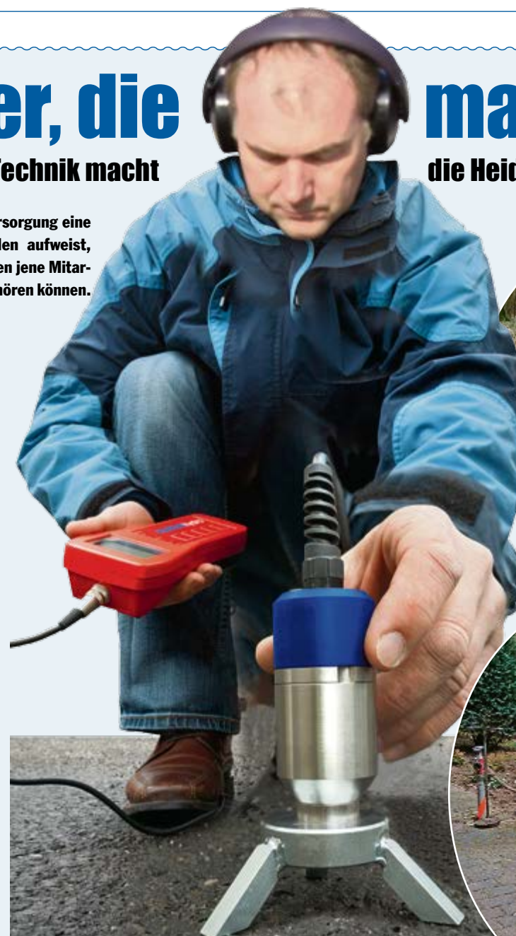
Hören – Sehen – Wasserverluste finden: Heiko Bartel lokalisiert sie mit einem Bodenmikrofon. Fotos (3): Heidewasser GmbH/SPREE-PR
