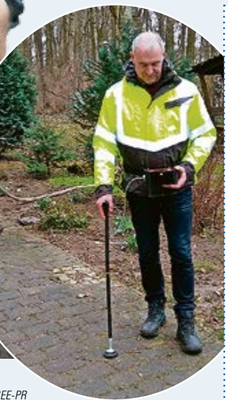
Das Spürgas strömt auch durch kleinste Löcher aus.
