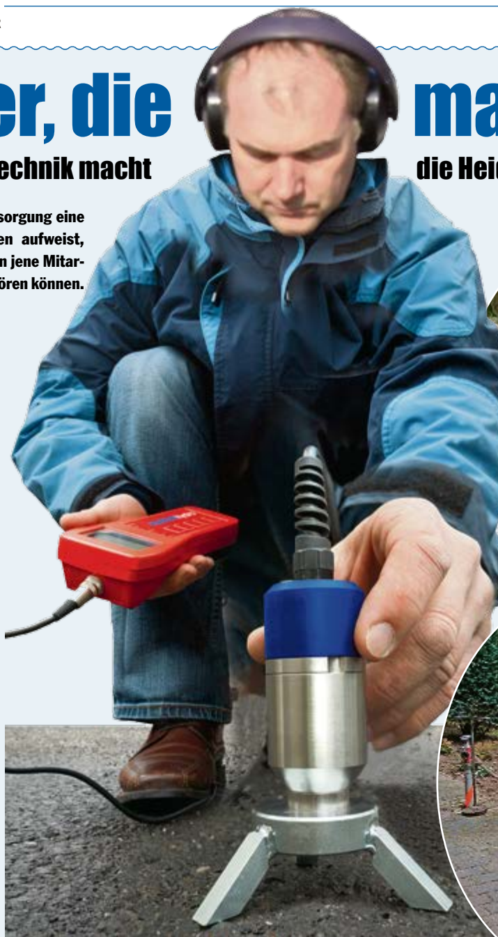
Hören – Sehen – Wasserverluste finden: Heiko Bartel lokalisiert sie mit einem Bodenmikrofon. Fotos (3): Heidewasser GmbH/SPREE-PR
