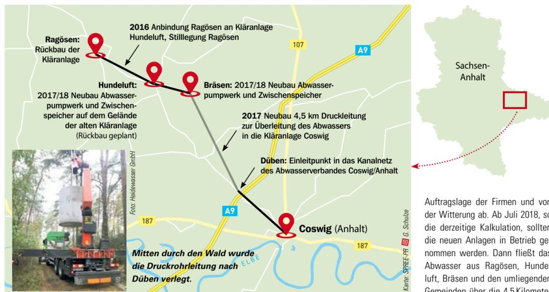
**Die Arbeiten an einer neuen und wirtschaftlichen Lösung der Abwasserentsorgung im Bereich Ragösen, Hundeluft und Bräsen gehen voran. Der erste Teil des Projekts wird in diesen Tagen abgeschlossen: der Bau einer Druckleitung von Bräsen zum Einleitpunkt in Düben.**
