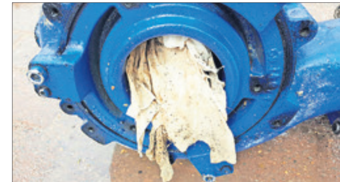
Die Reinigung verzopfter Pumpen wie diese in der Kleinen Gartenstraße ist extrem aufwändig.
