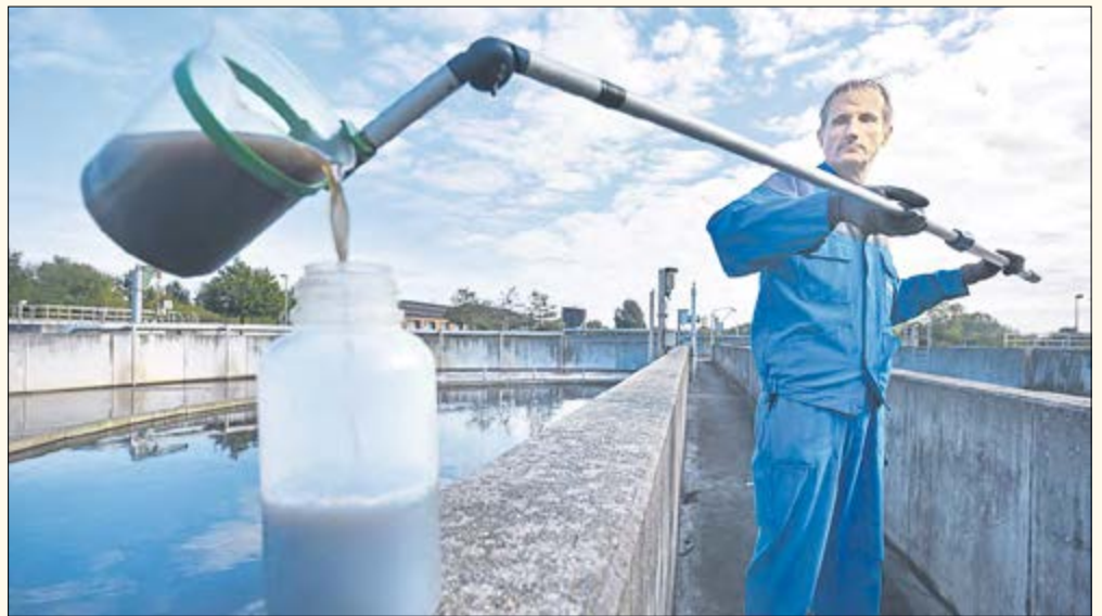
In der Kläranlage Schönebeck gehören Beprobungen des Abwassers zu den täglichen Pflichtaufgaben der Mitarbeiter. Foto: OEWA/Kehrer
