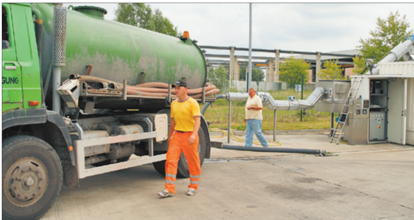
Ralph Henseleit (vorn) von der Firma BeSt-Service Abwasserentsorgung hat gerade über seinen Saugwagen Schmutzwasser in die Fäkalannahmestation abgelassen. Eigenbetrieb-Mitarbeiter Klaus Pankraz prüft die Transportbescheinigung.
