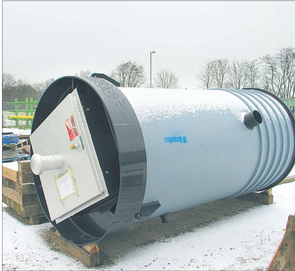
Blick von Außen: Pumpen wie diese befördern das Abwasser zur Kläranlage.
