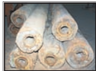
Wasserrohrleitungen aus vorindustrieller Zeit: Der von beiden Seiten aufgebohrte und geflößte Holzstamm war drei bis vier Meter lang. Die hohlen Baumstämme wurden anschließend mit Metallringen verbunden und mit Pech oder Asphalt abgedichtet. Noch heute treten bei Kanalbauarbeiten in Weißenfels die historischen Leitungen zutage.
