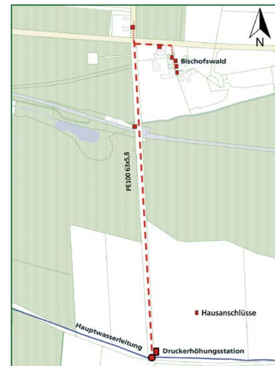
Die rote Linie zeigt die neue Anbindung der Ortslage Bischofswald an die Hauptleitung.
