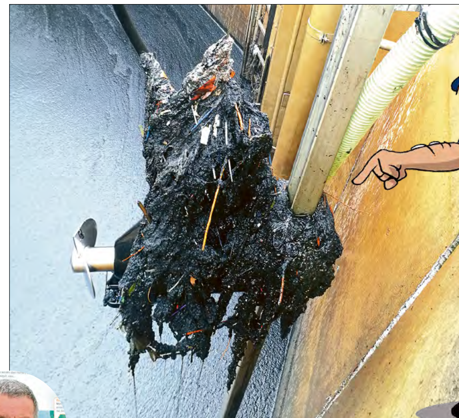
An jedem der fünf Rührwerke sammelt sich pro Monat eine gute halbe Karre Müll. Er muss mühselig per Hand entfernt werden. Foto: Keweloh/AVH
