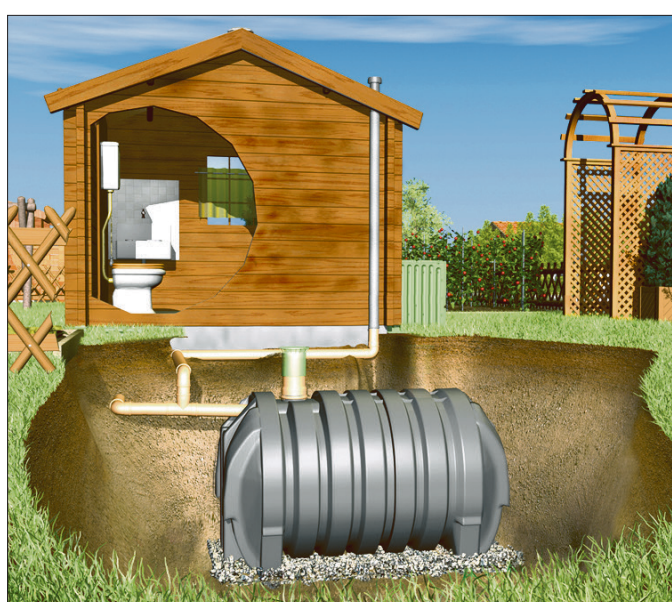
Eine Sammelgrube kommt zum Einsatz, wenn ein Anschluss an die zentrale Abwasserentsorgung technisch unmöglich ist.
