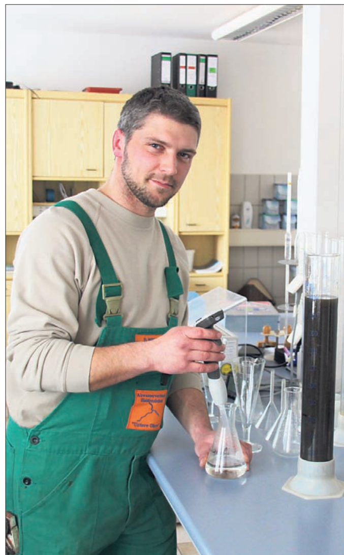
Jeden Morgen entnehmen die Klärwärter (hier Daniel Wille) aus den drei Vorklärbecken je einen Liter Schlammwasser. Nach einer halben Stunde steht das Schlammvolumen fest. Das bestimmt die weiteren Schritte bei der Abwasser-Wäsche.
